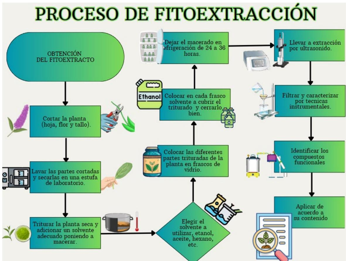
**Figura 1.** Representación esquemática del proceso de obtención de un fitoextracto.
