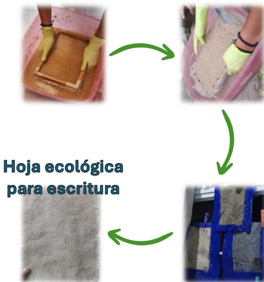
Figura 3. Proceso gráfico resumido de la elaboración de hojas ecológicas para escritura a base de lirio acuático.
