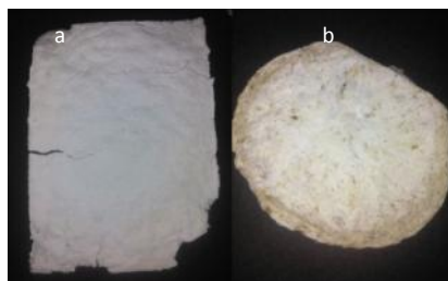
Fig. 1. Espumas solidas a base de almidón (a) y mezclas de almidón con fibra de maguey (b)
