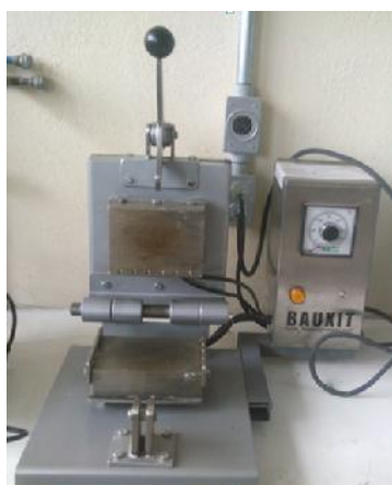
Fig. 1. Prensa de termoformado para la elaboración de espumas solidas
