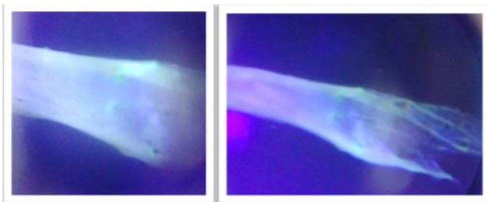
**Figura 2.** Microfibra excitada a una longitud de onda de 460 nm
