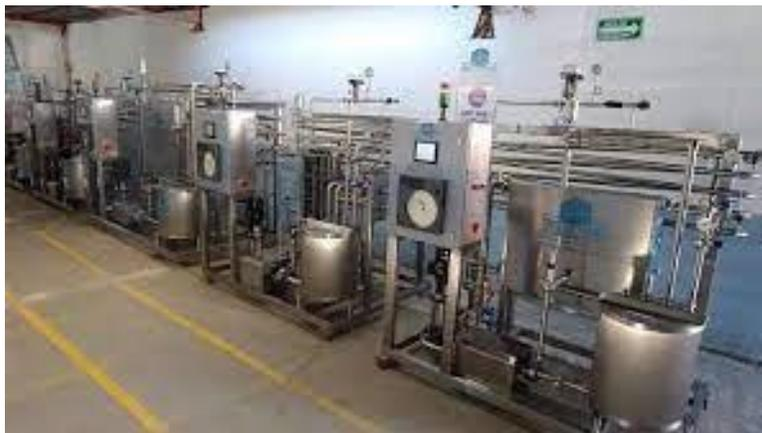
**Fig. 2.** Batería de pasteurizadores industriales de pulque fabricados por AMG Industrial. Tomado de [www.amgindustrial.com](http://www.amgindustrial.com).
