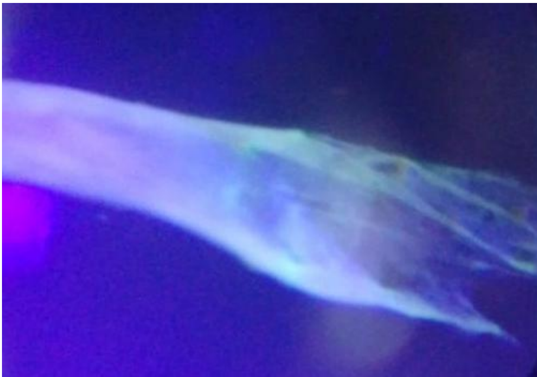
Fig. 1. Micrografía en campo claro de las microfibras compuestas de PVA al 10% y extracto de cúrcuma con etanol en proporción 1:1 (E1), excitada a una longitud de onda de 460 nm
